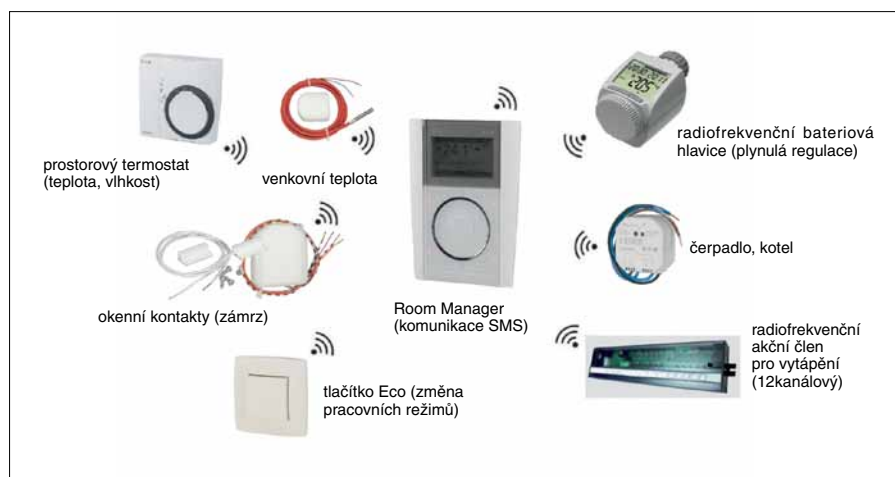
Obr. 1. Topologie řízení vytápění a chlazení řídicí jednotkou Room Manager
